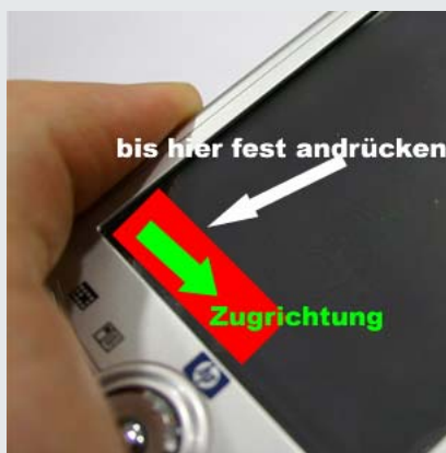
Grafik 1: Entfernen einer Folie mit Tesafilm
