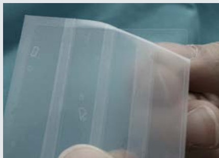
Grafik 2: Folie in Bahnen mit Tesafilm beschichten
